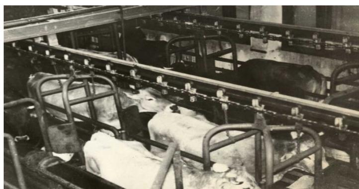
*Рис. 4. Фрагмент двухрядного параллельно-поточного кормового конвейера, колхоз им. Ленина*
