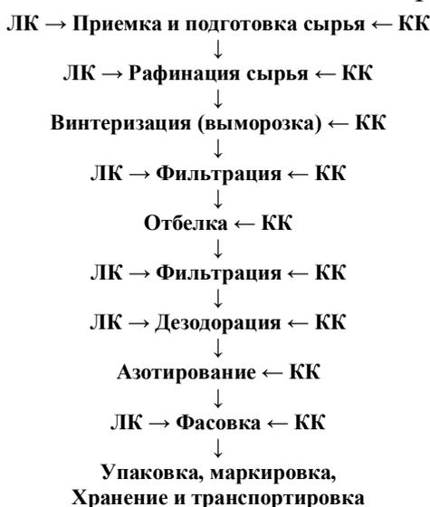
Рис. 1. Технологическая схема производства подсолнечного масла и контроля его качества: ЛК – лабораторный контроль; КК – цеховой контроль качества
