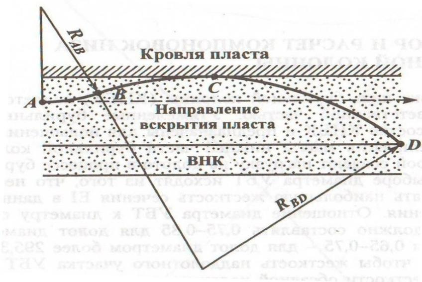
Рис. 5 Схема расположения горизонтального участка в пласте
