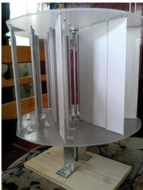
*Рис. 1 Модуль преобразования энергии ветра во вращающий момент приводного вала ветрогенератора*
