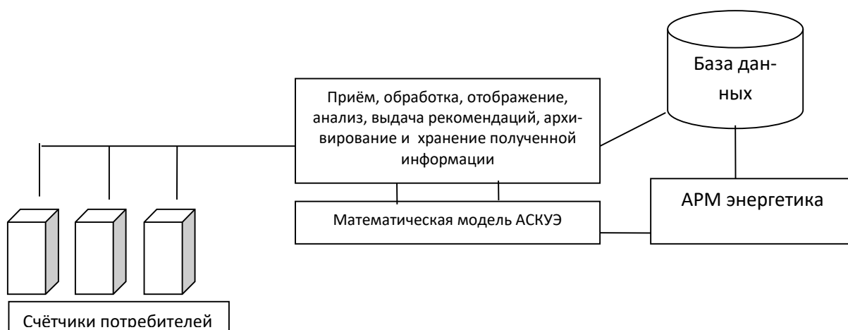
Рис. 2 Блок-схема АСКУЭ с возможностью имитационного моделирования
