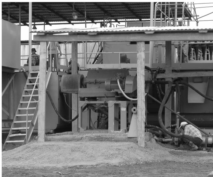
*Рис. 2 Модуль тонкой очистки на базе центрифуги ОАО «НК Роснефть-Дагнефть»*
