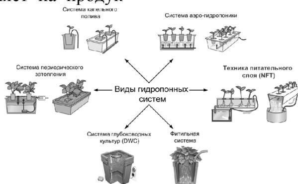
Рис. 1 Виды гидропонных технологий
