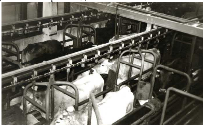
Рис. 1 Фрагмент двухлинейного комового конвейера на молочном комплексе, рассчитанном на 1000 голов коров
