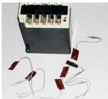
Рис. 6 Внешний вид устройства УВТЗ-5М с позисторами
