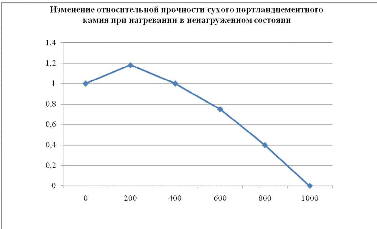
*Рис. 2. Изменение относительной прочности сухого портландцементного камня при нагревании в ненагруженном состоянии*
