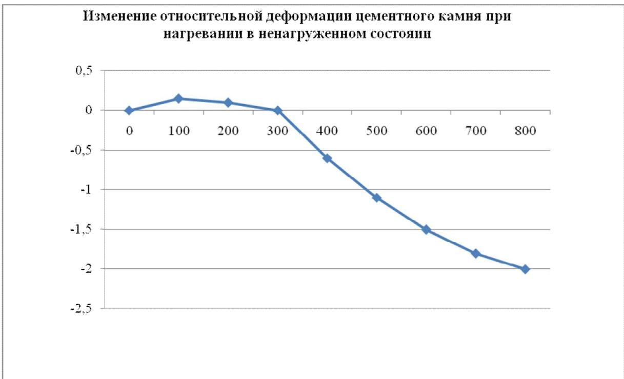
*Рис. 3. Изменение относительной деформации цементного камня при нагревании в ненагруженном состоянии*
