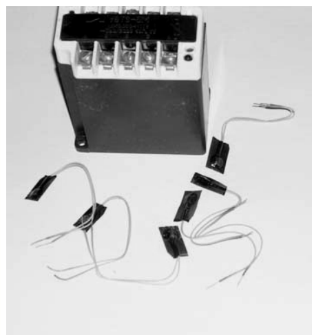
Рис. 1 Зависимость сопротивления позистора от температуры и внешний вид устройства УВТЗ с позисторами
