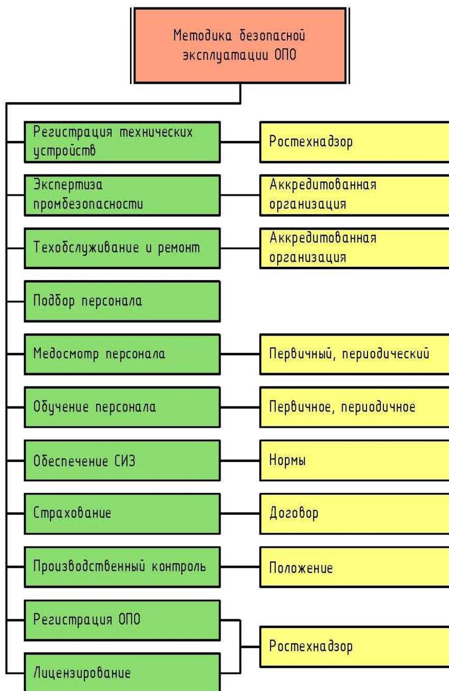
*Рис. 2 Методика организации безопасной эксплуатации подъемного сооружения, входящего в состав опасного производственного объекта*
