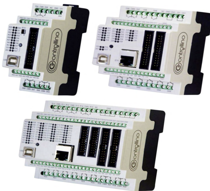
Рис. 2 ПЛК Controllino: MINI (слева), MAXI (по середине) и MEGA(справа)
