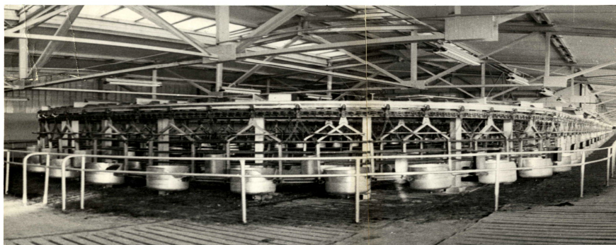
Рис. 1 Общий вид кормового конвейера с косым расположением животных, п. Кудьма
