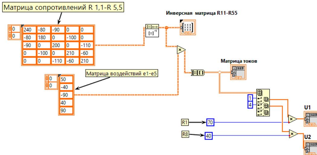
Рисунок 2 - Принципиальная схема модели расчета контурных токов
